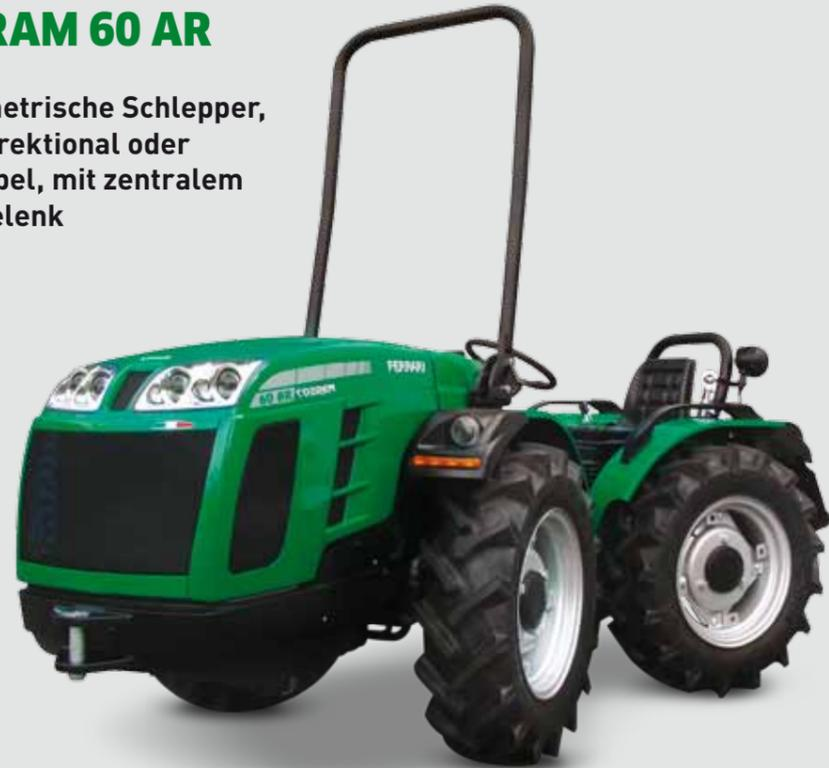
Die **Cobram 60 AR** Schlepper sind gebaut um auf extrem engen Terrain eingesetzt zu werden: Reihenkulturen, Weinbau, Obstbau, Glashaus und Baumschulen etc. Die 4 gleichgroßen Räder (isodiametrisch), der Rahmen mit zentralem Knickgelenk und das Pendelgelenk sind die Grundlage für diese hervorragende Bodenhaftung und extreme Wendigkeit.
