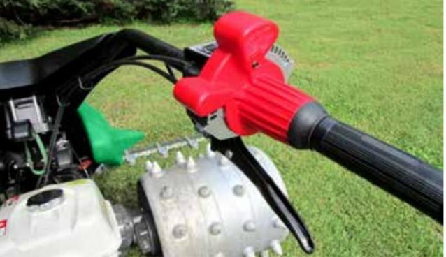
Beide Steuerungssysteme sind mit einer feinen Rasterung ausgestattet wodurch die Einstellung präzise gehalten wird. Ein mittlerer Teil ohne Rasterung ermöglicht eine freie Positionierung des Hebels oder des Griffs, was für eine präzisere Steuerung der Maschine bei ganz geringen Geschwindigkeiten nützlich ist.
