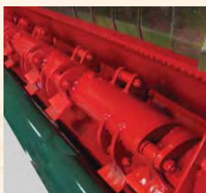
• Häckselrotor mit Schlegelhämmern
