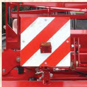
Beleuchtung mit Warntafeln
